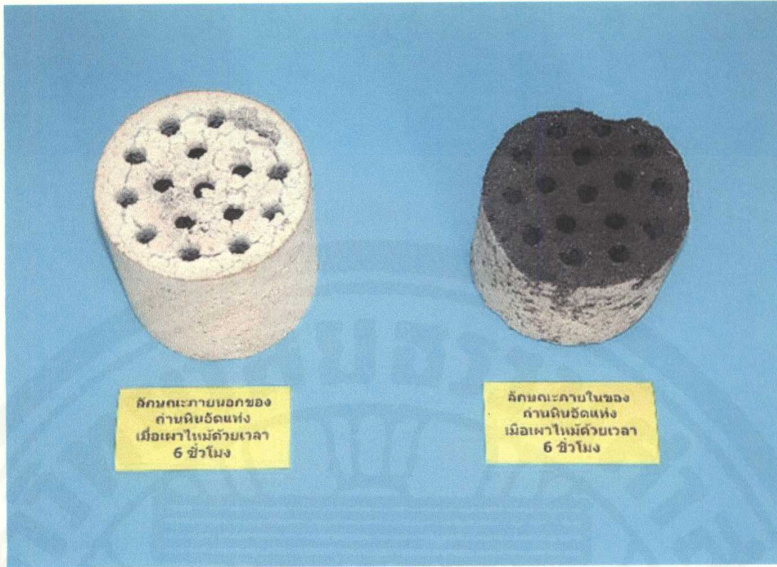
รูปที่ 3.1 ลักษณะภายนอกและภายในเนื้อถ่านหินอัดแท่ง ที่ผ่านการเผาไหม้ ที่อุณหภูมิ 800 องศาเซลเซียส ด้วยเวลา 6 ชั่วโมง
