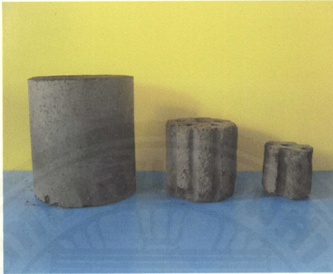
รูปที่ 4.10 ถ่านหินอัดแท่งขนาดเส้นผ่านศูนย์กลางและความสูง 12, 7.5, และ 5.5 เซนติเมตร ตามลำดับ
