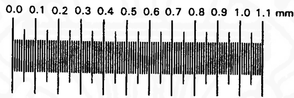
รูปที่ 1-3 สเกลของ stage micrometer
