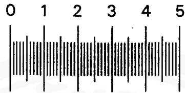
รูปที่ 1-2 สเกลของ ocular micrometer
