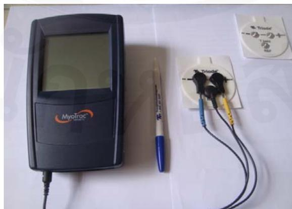
3. ดึงแผ่นหลังของ Form pad ออก ติดด้านกาวลงบนผิวหนังตรงตำแหน่งที่ได้คัดเลือกเอาไว้แล้ว กดลงเบาๆ โดยให้ด้านสัมผัสทั้ง 3 นั้น ประกอบลงบนผิวหนังเต็มพื้นผิว เมื่อติด Sensor ลงบนผิวหนังเรียบร้อยแล้ว ต่อสายจาก Sensor เข้ากับตัวเครื่องที่ Channel A หรือ B
