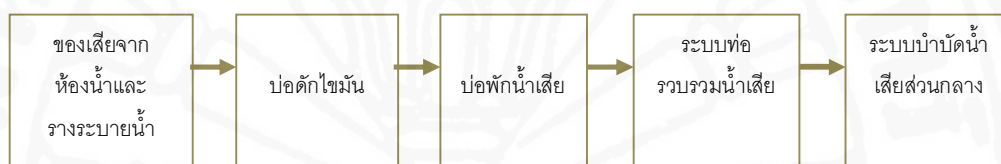
ภาพที่ 5.10 รูปแบบระบบบำบัดน้ำเสียของศูนย์ฯ
