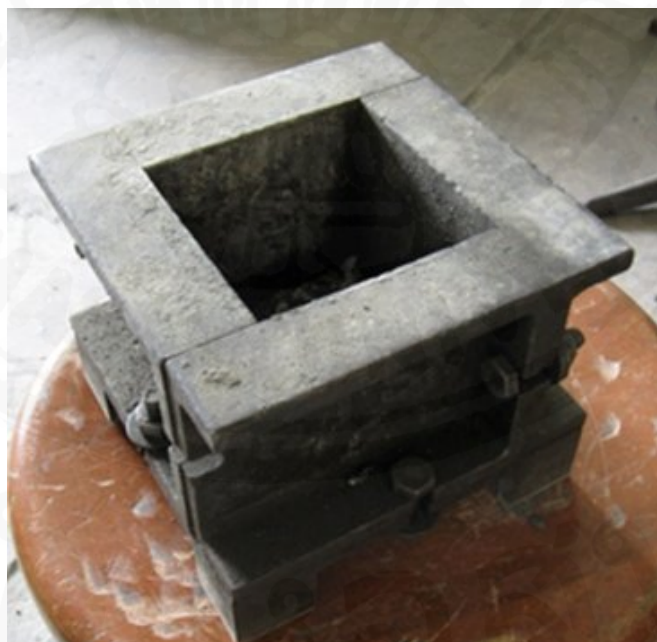
ภาพที่ ค.8 แม่แบบของบล็อกเหล็ก ขนาด หนา x ยาว x สูง ได้แก่ 10 x 10 x 10 ซม.
